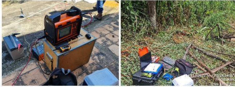
Figura 1. Línea de sísmica y tomografía eléctrica.
