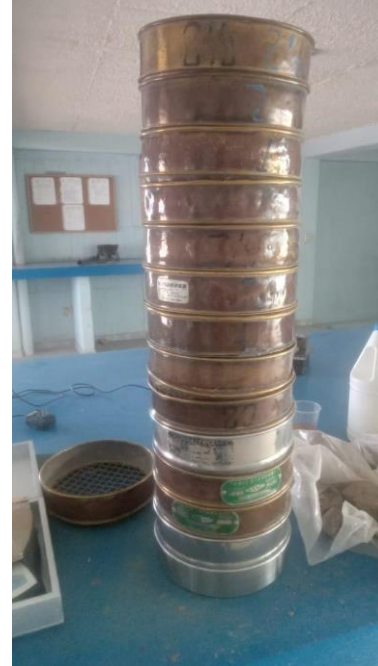
Figura 7. Set de tamices para granulometría.
