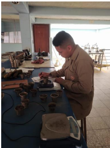
Figura 8. Realización de ensayo de LL.
