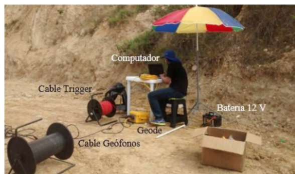
Figura 2. Componentes del equipo de refracción sísmica. Fuente: Autores (2020)
