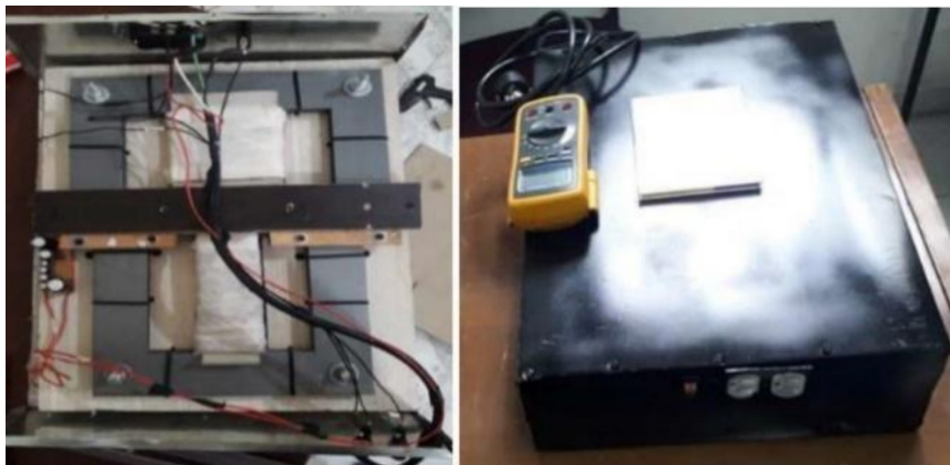
Figura 10. a) y b) Transformador de voltaje constante basado en ferro resonancia implementado.
