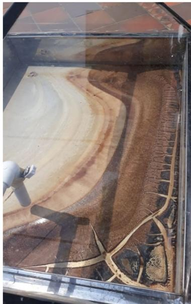
Figura 1. Lodo residual después del proceso de evaporación ambiental de lixiviados.
