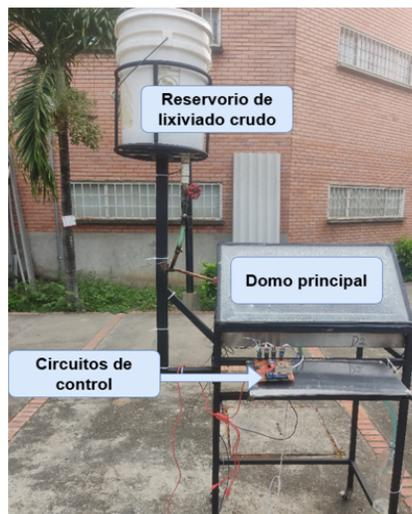
Figura 3. Prototipo experimental. Fuente: Autores.
