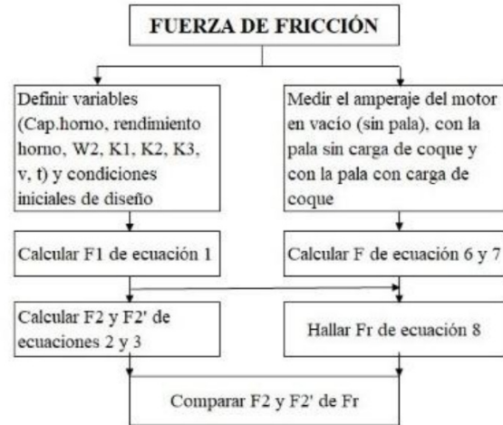
Figura 3. Resumen del procedimiento para el cálculo de la fuerza de fricción.
