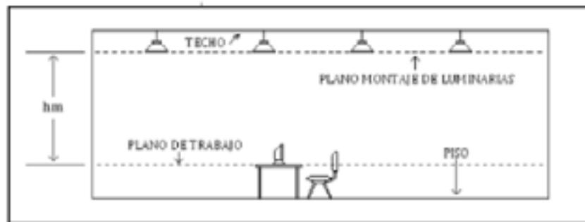
Nota: en la ilustración anterior se evidencian las cavidades del local para el cálculo del coeficiente de utilización.
