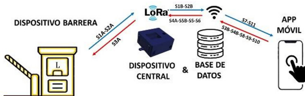
Figura 3. Esquema del prototipo de acceso de control
